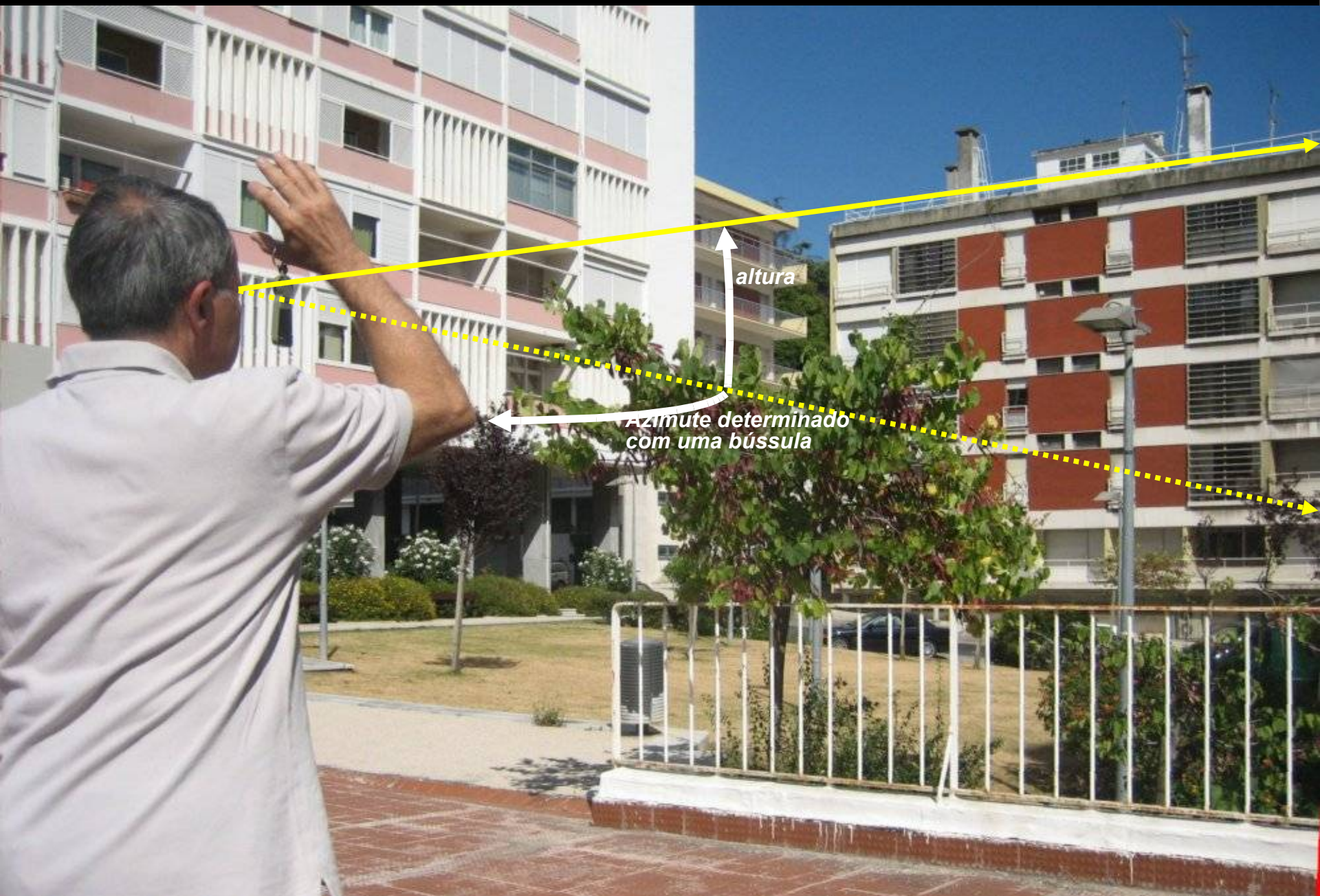
Determinação expedita da altura de um ponto do horizonte de um lugar usando um clinómetro
